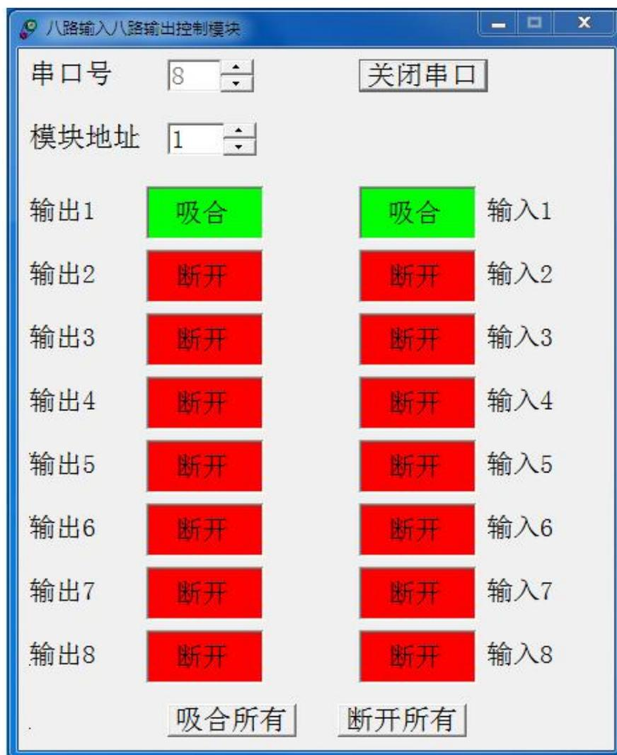
上图为继电器控制板通过 485 总线与软件连接后图示，软件可以显示输入状态，也可以控制继电器输出动作。
