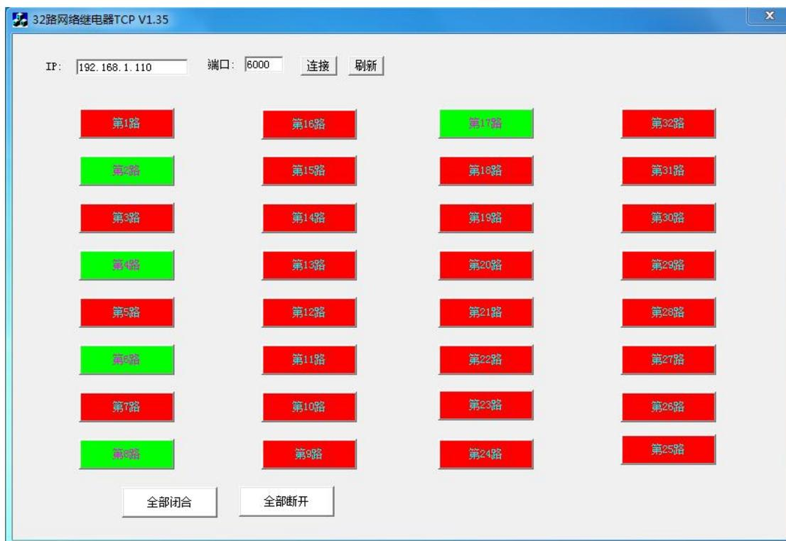
输入输出产品，1-16 路代表 1-16 路继电器输出，17-32 路代表 1-16 路输入。上图为继电器控制板与软件连接成功后
